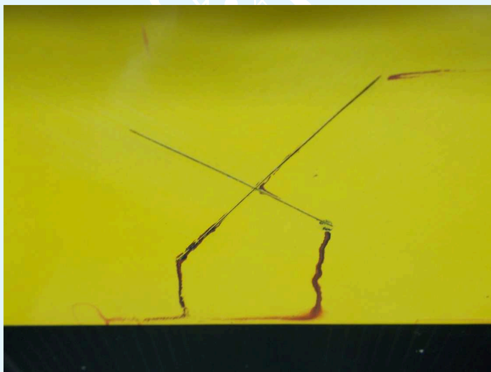
Fotografie dei particolari delle incisioni dei campioni "1" e "2" al termine delle prove.
